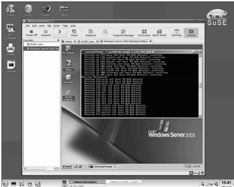
VMware Workstation 5.5: Im Bild sehen Sie, wie Windows Server 2003 in einer virtuellen Maschine läuft. Die VMware-Software selbst ist auf SUSE Linux 10.0 64 Bit installiert.
