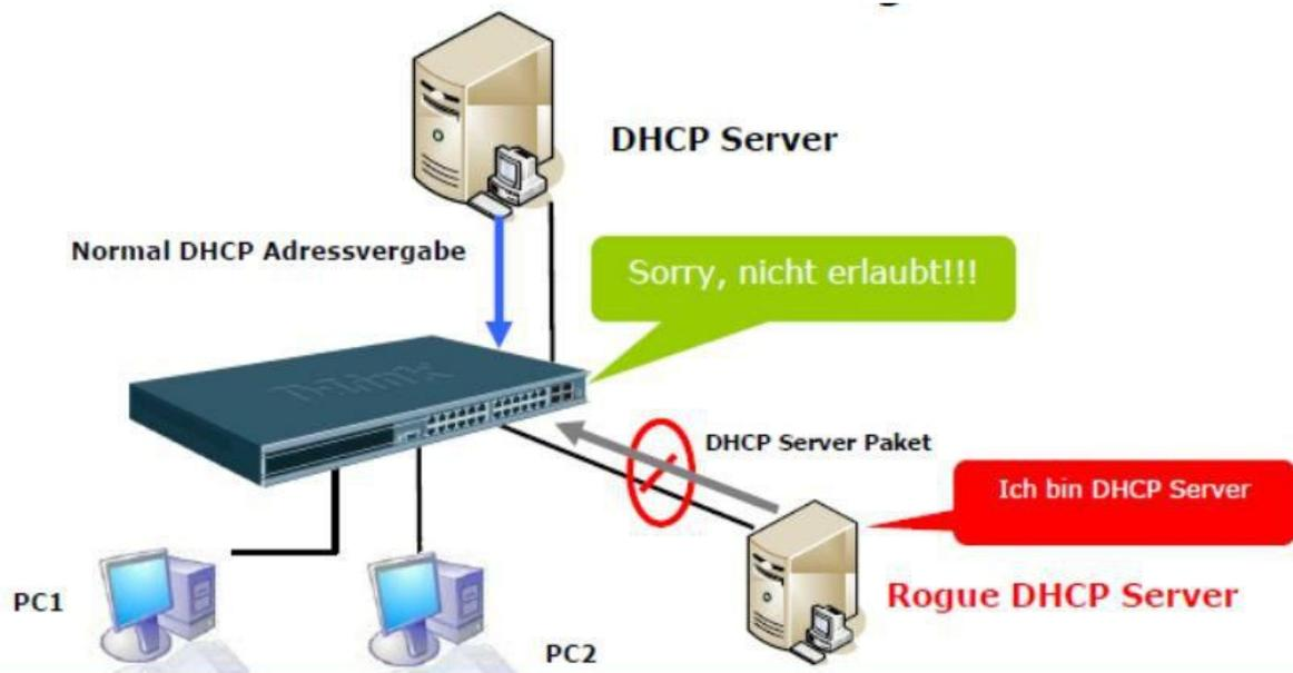
Störenfriede: Unerlaubt installierte DHCP-Server stören den Netzbetrieb. (Quelle: D-Link)
