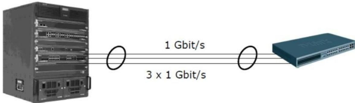
Speed: Es muss nicht immer gleich zehn Gigabit Ethernet sein, die Bandbreite lässt sich auch per Trunking erhöhen. (Quelle: D-Link)
